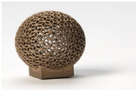
Slika 16. Gotov proizvod DMLS tehnologije [13]
